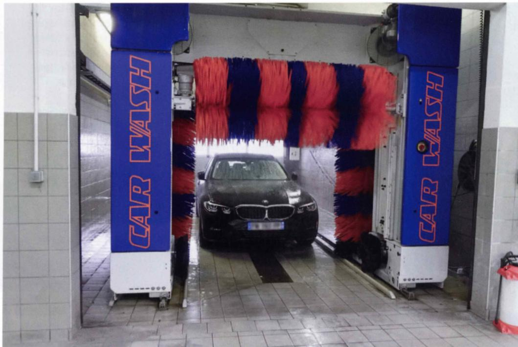
Le portique Leanus, spécialement conçu pour les concessions auto, va effectuer diverses étapes de lavage visant à dégraisser la carrosserie (prélavage, projections de jets d'eau puissants, passage des brosses, puis séchage...) et ce en peu de temps.
