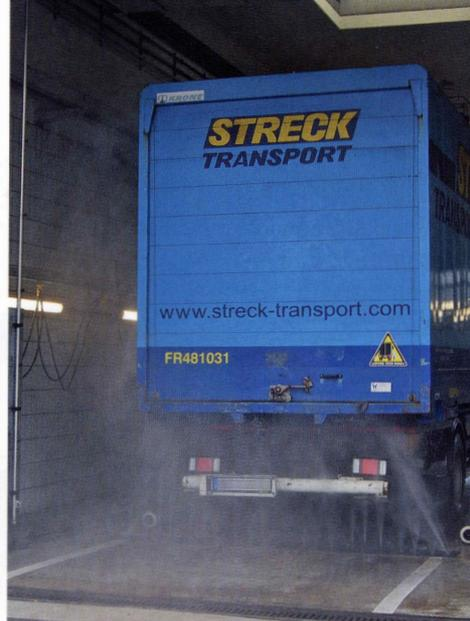
**Unterbodendüsen in der Anlage reinigen das Nutzfahrzeug von unten.**
