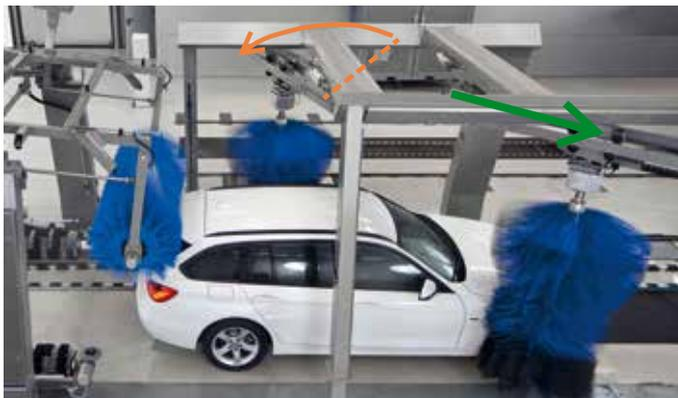
Laufschiene links schwenkt in Heckwäscheposition (orangener Pfeil). Seitenwalze rechts wird vom Pkw nach rechts außen geschoben = Frontwäsche rechte Seite (grüner Pfeil).
