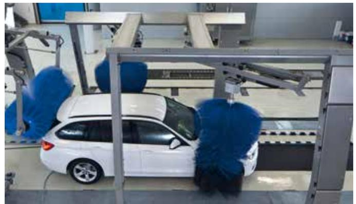
Seitenwalze links wäscht die Seitenfläche links. Seitenwalze rechts wäscht die Seitenfläche rechts (Laufschiene rechts steht noch nicht in Heckwäscheposition).
