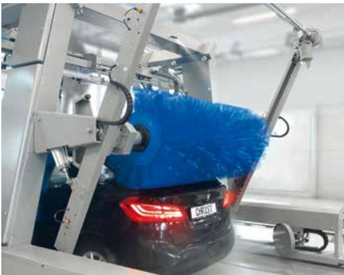
Laufschiene steht in Position Heckwäsche.
