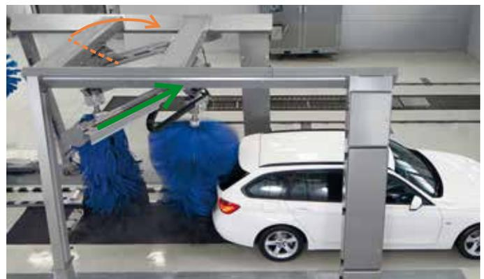
Laufschiene links schwenkt wieder in Frontwäscheposition. Das nächste Auto kann kommen. Seitenwalze rechts läuft dem Fahrzeug nach = Start Heckwäsche rechte Seite (grüner Pfeil).
