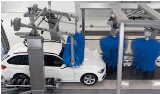
Start des Waschvorgangs am EVO-4. Das Fahrzeug wird gegen die rotierende linke Seitenwalze geschoben.
