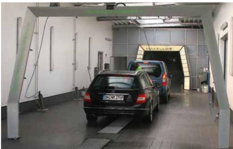
**Vorsprüheinrichtung, DURAPROTECT-Bogen, unbeleuchtet, DFB 3.550 mm**
