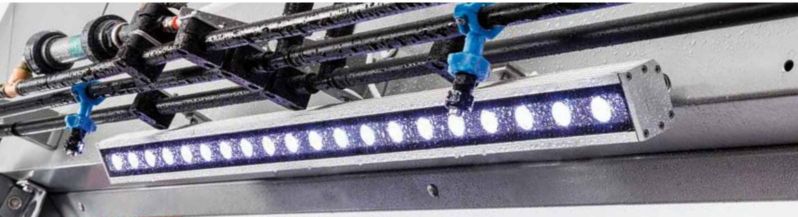
Die LED-Lichtorgel strahlt in den weißen Schaum und illuminiert diesen in der entsprechenden Farbe.
